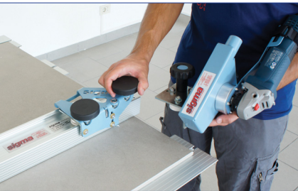
Inserimento sulla guida del KERA-CUT. Insertion on the KERA-CUT guide.
