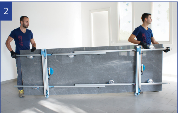
Trasporto con il KIT CARRELLO. Transport with the CARRIAGE KIT.
