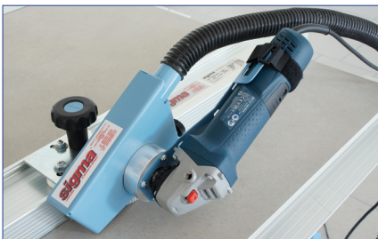
L'attacco è universale per qualsiasi tipo di aspirazione. Universal vacuum cleaner attachment.
