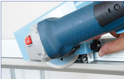
Facile regolazione della profondità di taglio. Easy adjustment of the depth stop.
