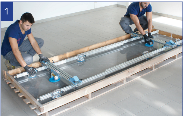
il KIT-CARRELLO viene fissato prima di estrarre la lastra. the CARRIAGE-KIT is fitted before the lifting of the tile.
